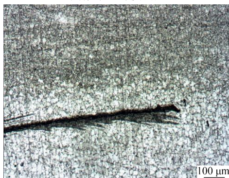
(b)裂纹尖端
